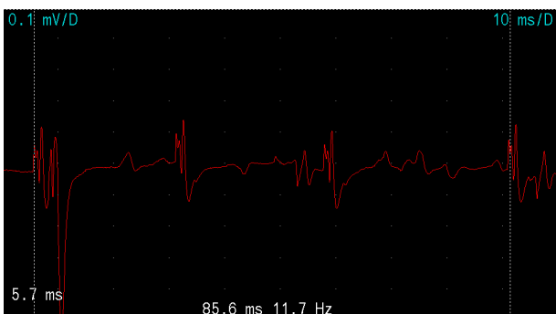
Obr. 3: Spontánní aktivita - pozitivní ostré vlny (PSW, monofazické potenciály s prudkou pozitivní výchylkou a postupným návratem k bazální linii).
