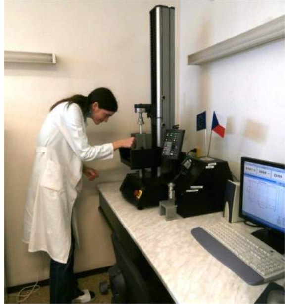
vkládání vzorků pro měření na přístroji Instron TPA
