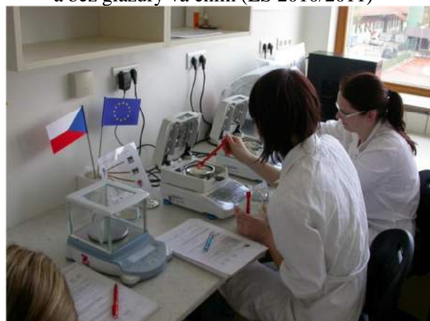
Stanovení obsahu vlhkosti fileťů na sušících vahách (LS 2011/2012)
