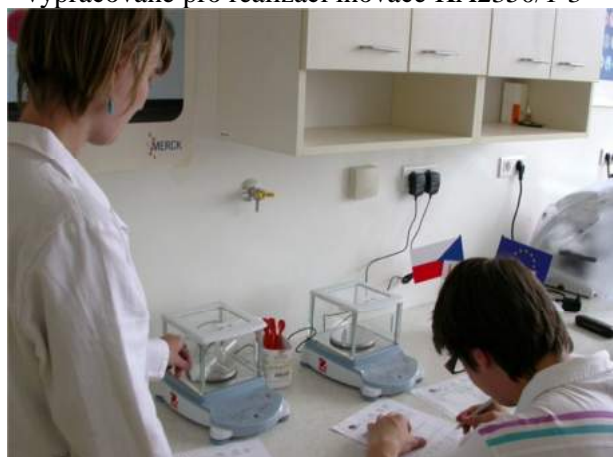
Stanovení hmotnosti prázdných frit před filtrací sraeniny chinolinfosfomolybdenanu (LS 2011/2012)
