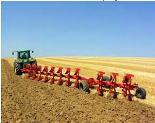
Obrázek č. 8: Orba oboustranným pluhem
