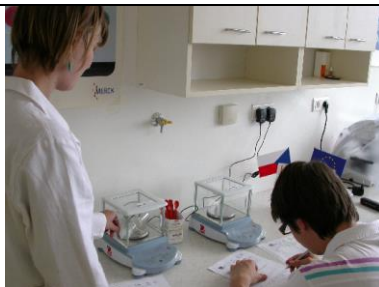
KA 1-2 Stanovení obsahu vlhkosti filetů na sušících vahách
