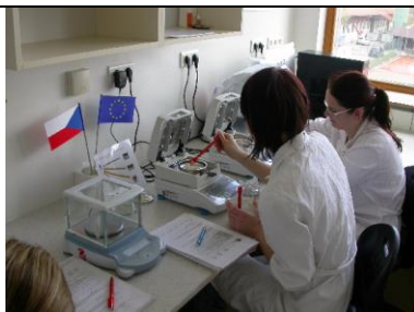
KA 1-2 Stanovení obsahu vlhkosti filetů na sušících vahách
