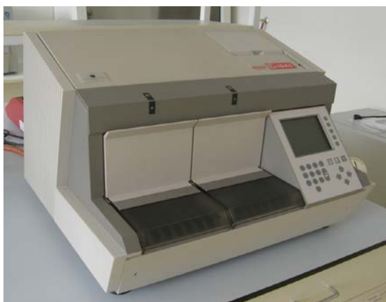
Obrázek 3: Přístroj VIDAS® veškeré kroky testu provádí automaticky, do přístroje se vkládá „špička“ SPR® a reagenční strip, na konci analýzy přístroj výsledky vytiskne
