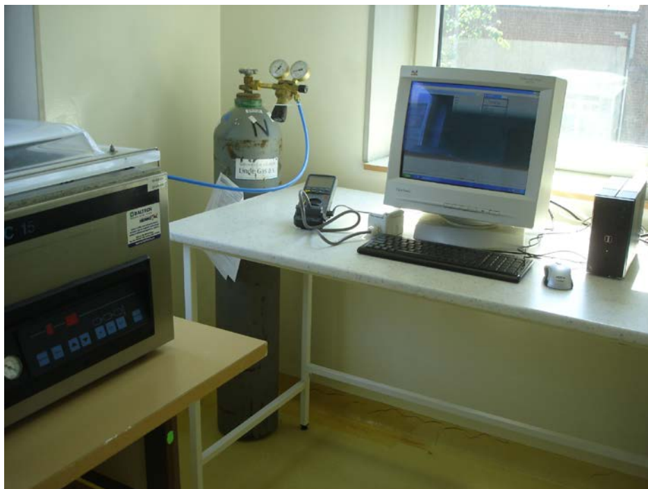
Obr. č. 1 Měření příkonu baličky: z levé strany Henkovac 150, tlaková lahev s N 2 a měřicí přístroj Metex M-3860M, PC
