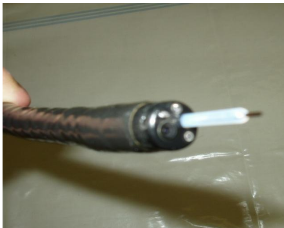
Obr. 1. Konec endoskopu s prográdní optikou - dva světlé body po stranách vedou světlo, vpředu je pracovní kanál na zavádění nástrojů, vzadu vlastní videokamera
