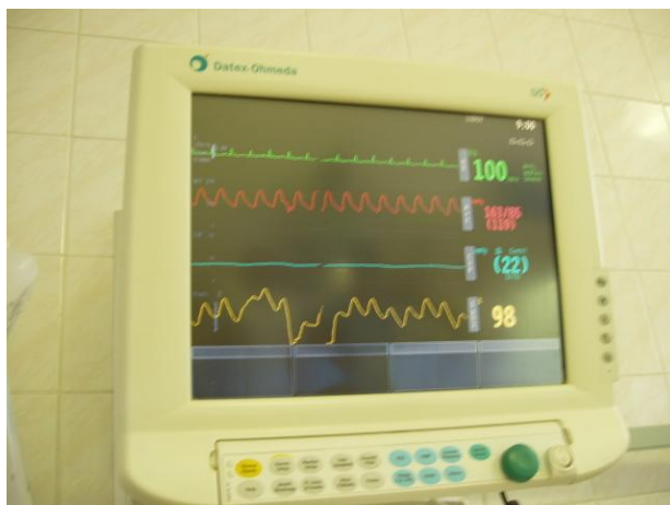
Obr. 7. Základní monitor - zeleně EKG křivka a číslem tepová frekvence, červeně arteriální tlaková křivka a číslem tlak, žlutě křivka saturace krve kyslíkem a číslem je výše v procentech
