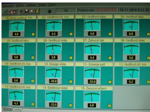
Obr. 35. Krevní deriváty musí být uchovávány za přesně monitorované teploty - obrazovka počítačem nepřetržitě kontrolované a monitorované teploty ledniček a mrazniček v hematologické laboratoři
