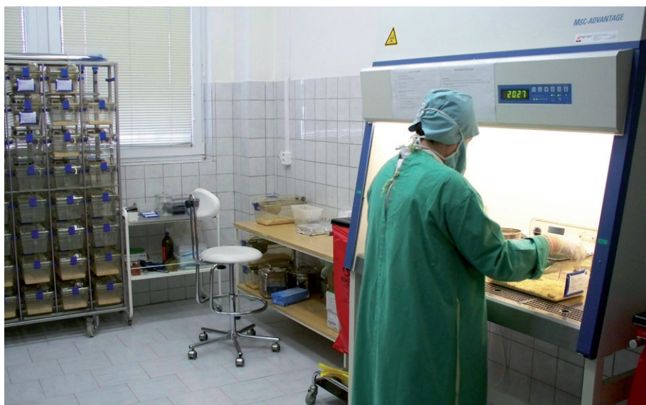
Obr. 4b - Manipulace se zvířaty, výměna steliva v kleci, dodání krmné směsi a napájecích lahví probíhá v laminárním boxu (v provedení biohazard) za sterilních podmínek. Box chrání před kontaminací jak pracovníka, tak laboratorní zvíře. Pracovník používá při manipulaci ochranný oděv a rukavice.
