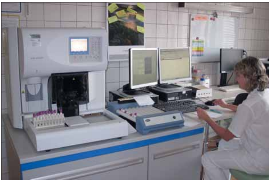
Obr. 3.2. - Automatický analyzátor Sysmex XE-5000, generující kromě základních parametrů KO i parametry erytrocytů, trombocytů a pěti-populační diferenciaci. Jedná se o technologii průtokového cytometru, využívající k analýze kombinace laseru a cytochemického barvení. Některé parametry jsou stanoveny pomocí lýzy buněk za specifických podmínek. HOK LF UP a FN Olomouc.
