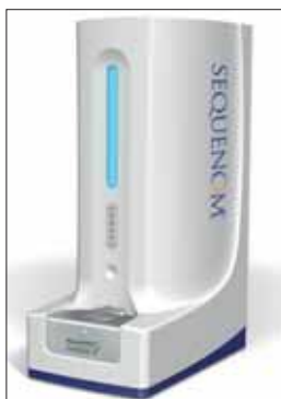
Obr. 2.55.- Genetický analyzátor zn. SEQUENOM, který kombinuje metody hmotnostní spektrofotometrie, molekulární biologie s pokročilou softwarovou analýzou.
