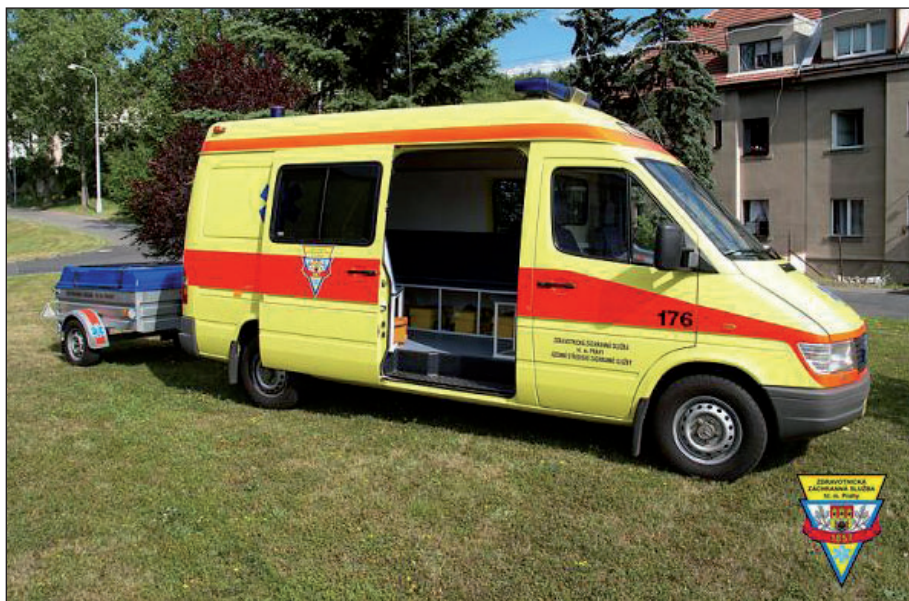
obr. 4.17. - Mercedes Benz - Sprinter, tzv. kyslíkový vůz - určený pro inhalaci kyslíku většího počtu pacientů
